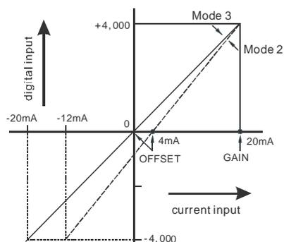
CR#1 mode 2: GAIN=20mA ( 4,000<sub>LSB</sub> ) · OFFSET=4mA ( 800<sub>LSB</sub> ) .
