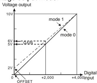
Mode 0 of CR#1:  $\text{GAIN}=5\text{V} ( 2,000_{\text{LSB}} ) \cdot \text{OFFSET}=0\text{V} ( 0_{\text{LSB}} ) .$
