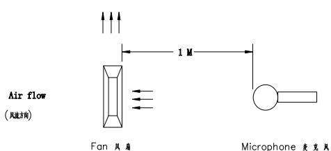
(在背景噪音不超过 18dB (A) 的无响室内, 将待测风扇通入额定的工作电压, 悬掉入空中, 将麦克风放于风扇同一平面且离待测风扇进风口 1 米处进行测试其 B&K 值)
